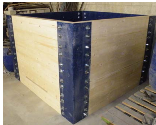
Figura 1: Contentor de ensaio instalado no Laboratório de Engenharia Civil da Universidade do Minho: a) Geometria e detalhes construtivos; b) Fotografia geral
